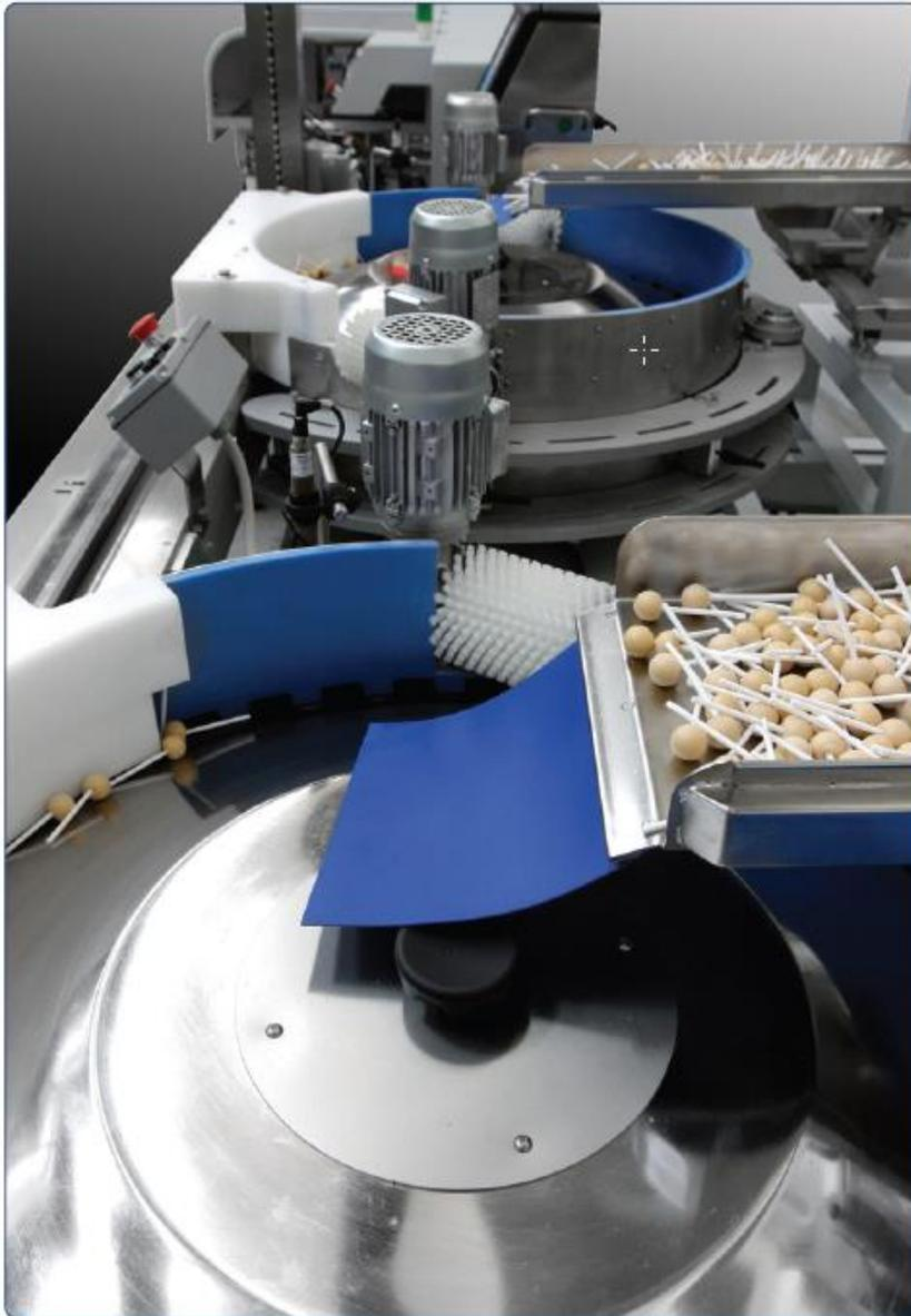
*Über zwei Drehteller, angetrieben von Kollmorgen- Torquemotoren, werden die Lollipops vereinzelt und der Verpackung zugeführt.*
