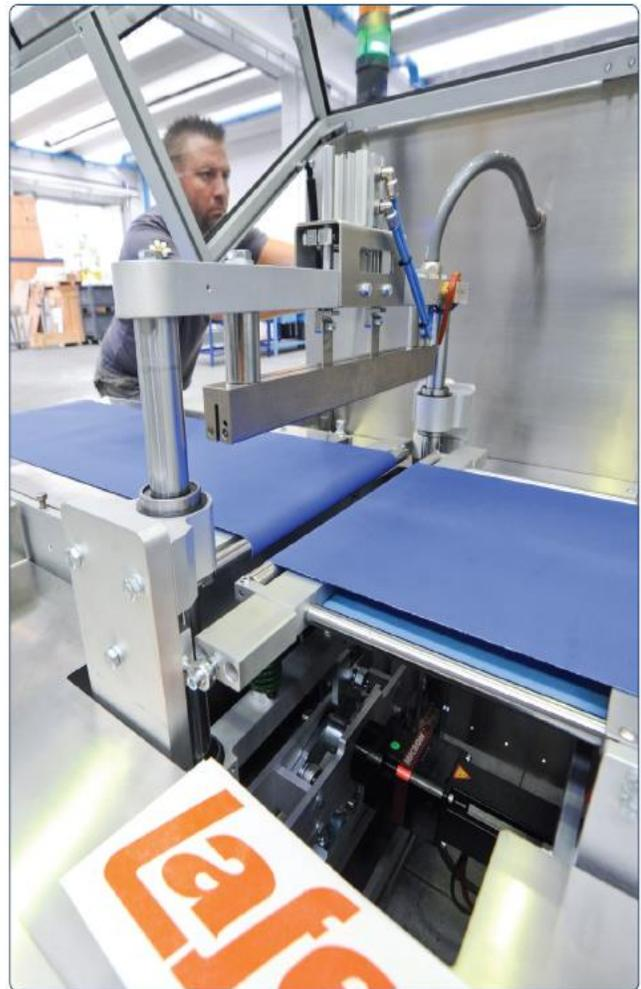
*Für den synchron zum Prozess mitlaufenden Schweißbalkenantrieb nutzt Lafer eine antriebsintegrierte Kurvenscheibenfunktion.*
